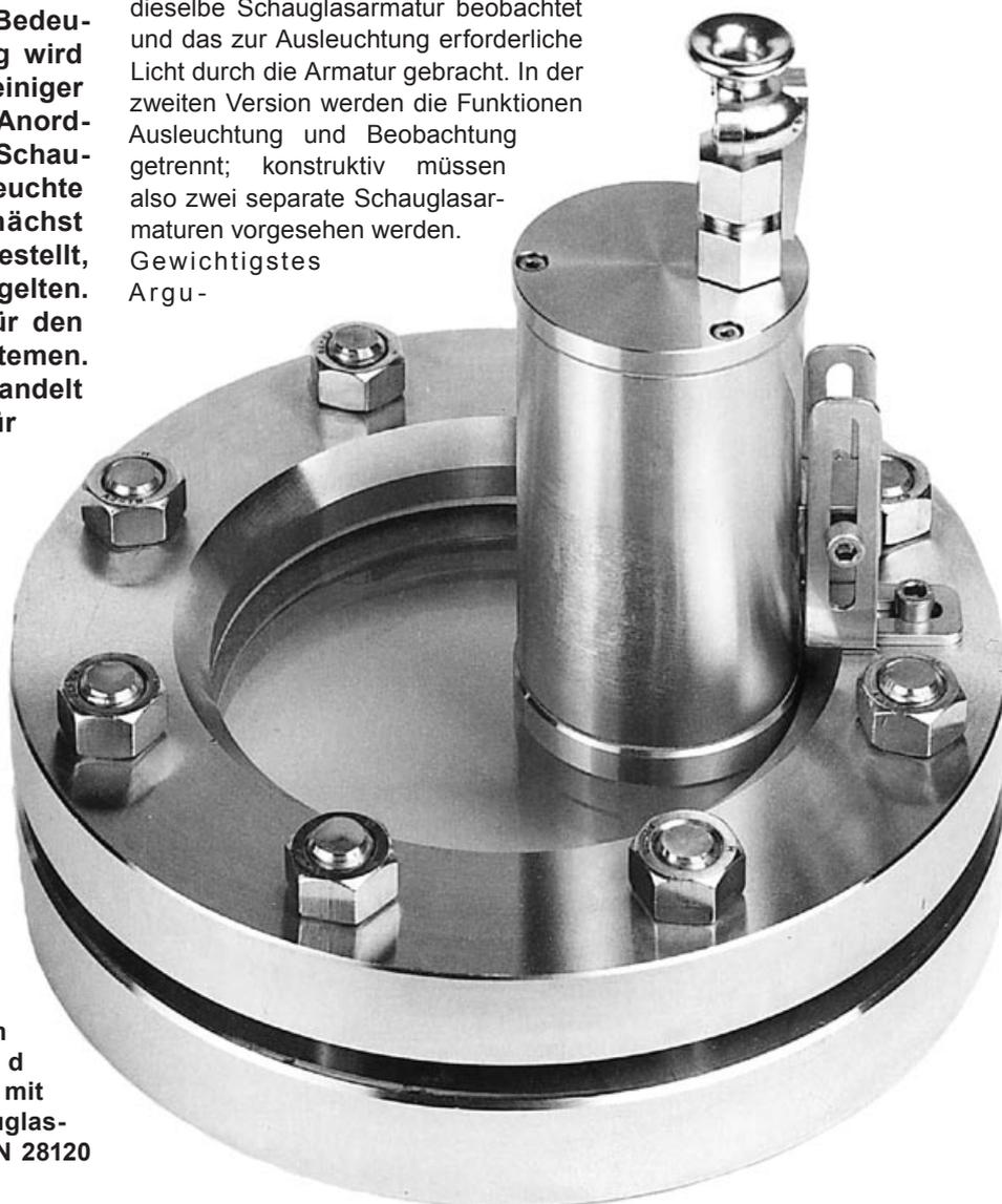
Abb.1 Leuchte Typ EdelEx, vollständig aus rostfreiem Stahl, 20 Watt, 24 Volt, EEx d IIC T4, Ex II 2 G + D, aufgebaut mit Kippscharnier auf eine Schauglasarmatur VETROLUX® nach DIN 28120
