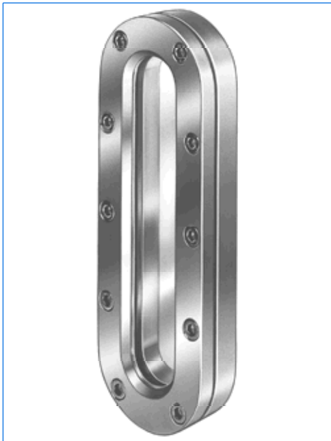
Hublot oblong, type LSGRR 1.4571-1.4571-2,5-2-SL-8903-KLINGERSil-Silicone. Version avec embase à trous borgnes, embase à souder et bride couvercle en INOX 1.4571, PN 2,5, dimensions 341 x 116 mm, verre selon DIN 8903, joints côté produit KLINGERSil C4400, côté couvercle silicone.
