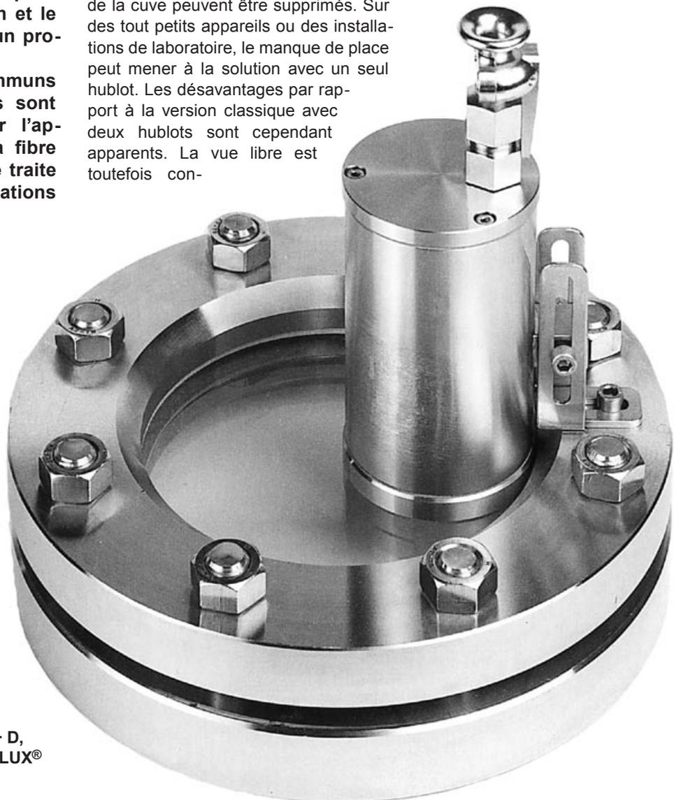
Photo 1: Projecteur type EdelEx 20dHSch, entièrement en INOX, 20 W, 24 V, EEx d IIC T4, Ex II 2 G + D, monté sur un hublot VETROLUX® selon DIN 28120
